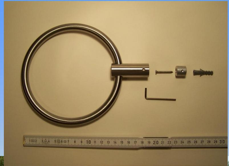
Der HS-Schutzring bildet in der Ringebene eine Wand aus aneinandergereihten virtuellen Ringen, die sämtliche in einem Winkelbereich von  $-45$  bis  $+45^\circ$  gegen das Einfallslot einfallende HS-Felder totalreflektiert.
